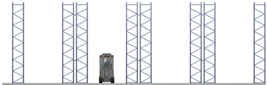
Sistema de rack selectivo más común formado por un rack sencillo adosado a la pared y racks dobles centrales
